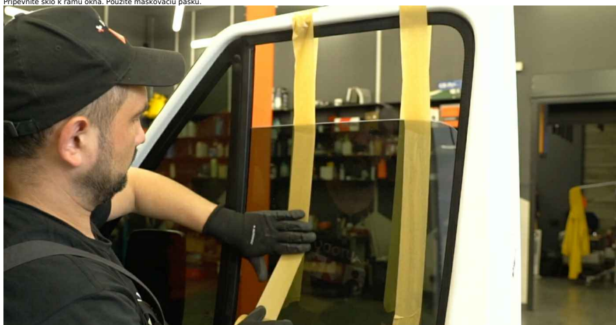
Pozor! • Pri zdvíhaní a upevňovaní skla ho držte, aby ste zabránili jeho poškodeniu a predišli zraneniu.
