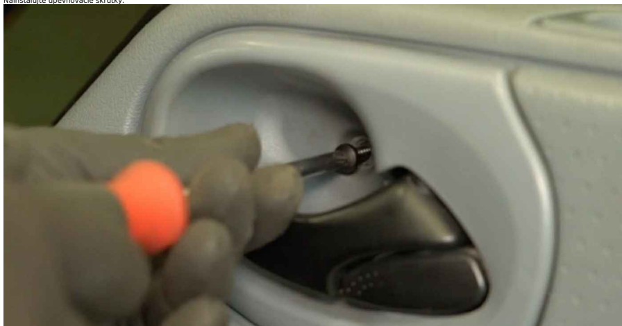
42 Uťahnite upevňovacie prvky panelu dverí. Použite križový skrutkovač.
