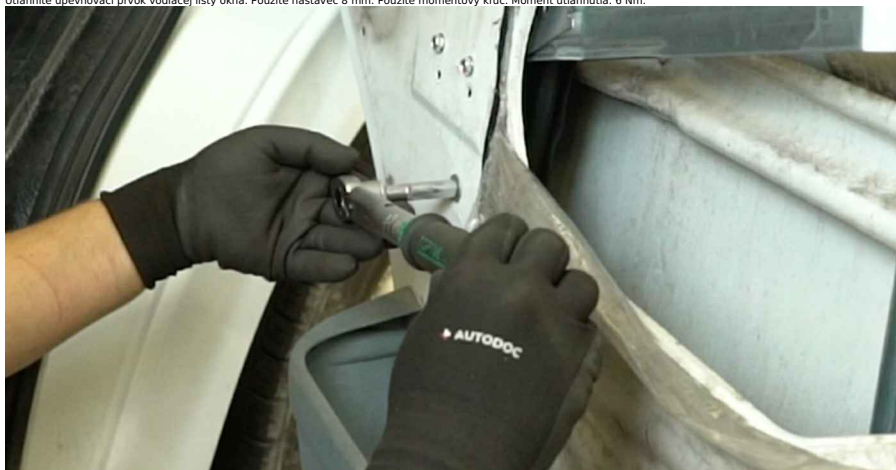
26 Nainštalujte nity spájajúce sklo s mechanizmom regulátora okien. Použite nitovač. Použite nity.
