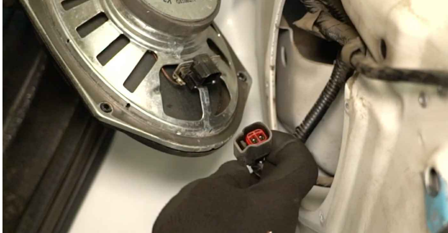
11 Odpojte konektor od motora elektrického ovládania okien.
