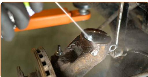
**46** Vyčistite upevňovací prvok na tyčke stabilizátora. Použite drôtenú kefu. Použite viacúčelový čistiaci sprej.
