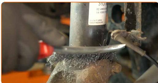
**21** Odsrutkujte upevňovací prvok držiaka kábla snímača ABS. Použite nástavec 18 mm. Použite ráčňový kľúč.
