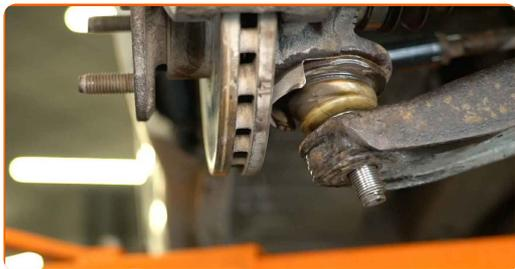
**72** Namontujte tyčku stabilizátora a naskrutkujte upevňovaciu maticu.
