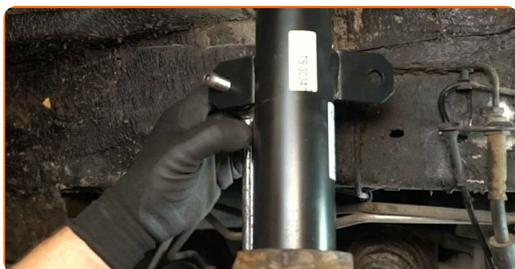
**73** Nainštalujte držiak kábla snímača ABS a naskrutkujte upevňovaciu maticu.
