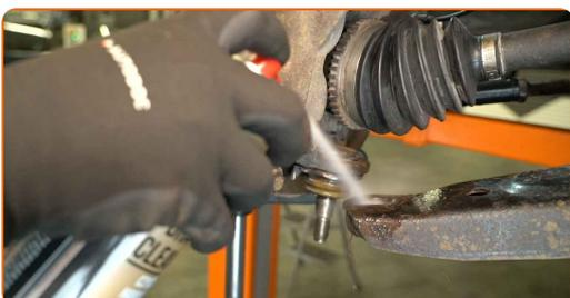
**71** Pripevnite guľový čap k ovládacímu ramenu a naskrutkujte upevňovaciu maticu. Použite montážnu páku.
