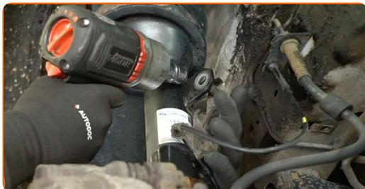
**23** Odskrutkujte upevňovací prvok spájajúci tyčku stabilizátora so vzperou zavesenia. Použite 19 mm kombinovaný kľúč. Použite šesťhranný nástavec H5. Použite ráčňový kľúč.
