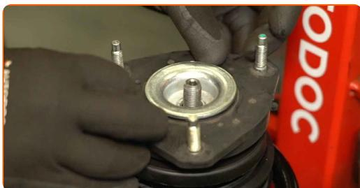
**60** Namontujte a utiahnite maticu piestnice vzpery. Použite nástavec na maticu vzpery 18 mm. Použite šesťhrannú predlžovaciu tyč H6. Použite momentový kľúč. Moment utiahnutia: 70 Nm.
