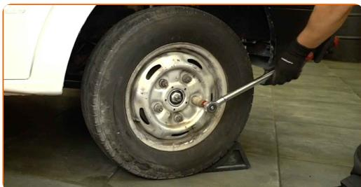
**85** Utiahnite maticu nápravy. Použite nástavec 36 mm. Použite momentový kľúč. Moment utiahnutia: 320 Nm.
