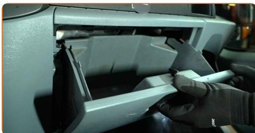
**3** Zatlačením na príchytky odkladacej skrinky ju odpojte.
