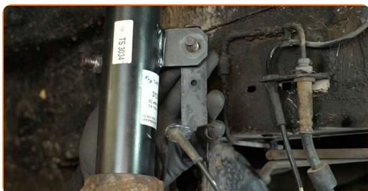
**74** Utiahnite upevňovací prvok spájajúci tyčku stabilizátora k vzpere zavesenia. Použite nástavec 19 mm. Použite momentový kľúč. Moment utiahnutia: 55 Nm.
