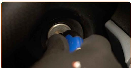
**32** Odpojte konektor od spínača elektrického okna.
