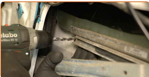
**14** Vyvrtajte nity spájajúce mechanizmus regulátora okien s dverami. Použite vrtačku. Použite sadu vrtákov.
