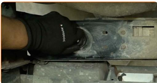
**33** Z chladiča odstráňte kryt ventilátora chladenia motora spolu s ventilátorom. Použite montážnu páku.
