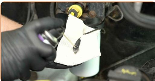
**9** Pripojte konektor snímača vody v palive.
