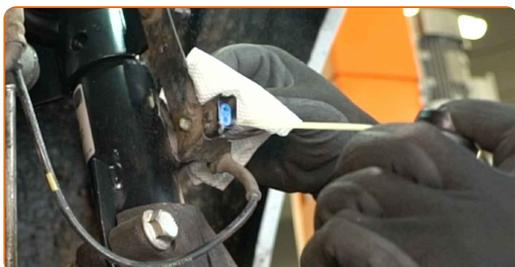
58 Pripojte konektor snímača opotrebenia brzdových platničiek.
