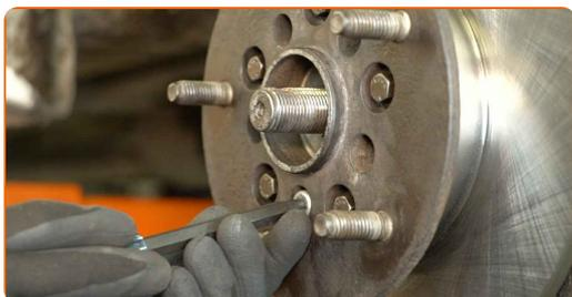
49 Utiahnite upevňovacie skrutky ložiska kola. Použite hviezdicový nástavec T50 Torx. Použite momentový kľúč. Moment utiahnutia: 53 Nm.
