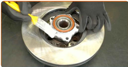
47 Namontujte náboj kola spolu s brzdovým kotúčom.
