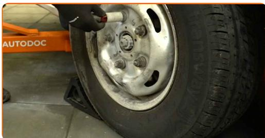
6 Odstráňte závlačku, ktorá zaisťuje upevnenie nápravy. Použite montážnu páku. Použite kliešte s dlhým nosom.
