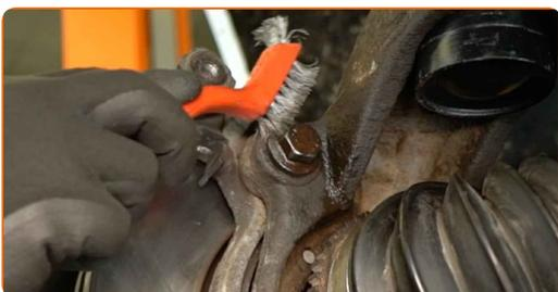
27 Odskrutkujte upevňovacie prvky držiaka brzdového strmeňa. Použite nástavec 18 mm. Použite otočný kolík.
