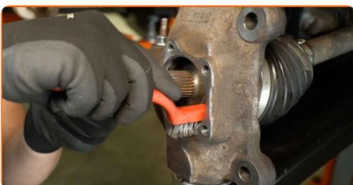
34 Vyčistite montážnu pozíciu držiaka brzdového strmeňa. Použite drôtenú kefu. Použite viacúčelový čistiaci sprej.
