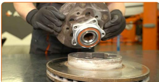
42 Vyčistite povrch brzdového kotúča, ktorý je v kontakte s diskom kola. Použite drôtenú kefu.
