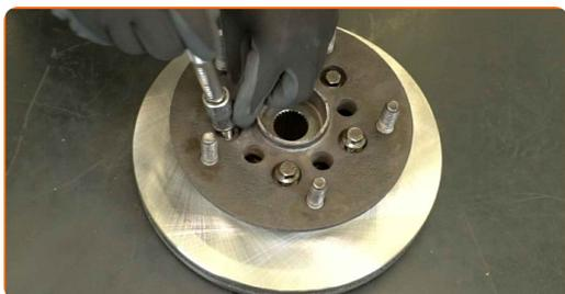
45 Naskrutkujte upevňovacie prvky brzdového kotúča. Použite nástavec 13 mm. Použite ráčňový kľúč.
