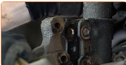
15 Odskrutkujte vrchné upevnenie vzpery tlmiča. Použite kombinačný kľúč č.19 Použite nástavec č.9. Použite ráčňový kľúč.
