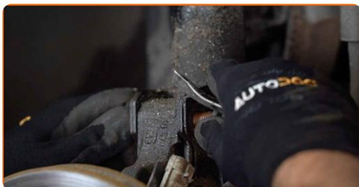
13 Odpojte držiak brzdovej hadičky od vzpery tlmiča. Použite páčidlo.
