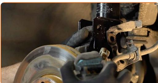
36 Upevnite brzdovú hadičku na vzperu.
