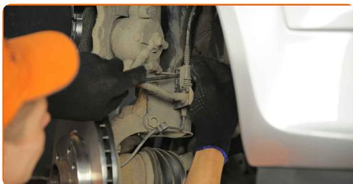
**11** Odpojte konektor ABS snímača.
