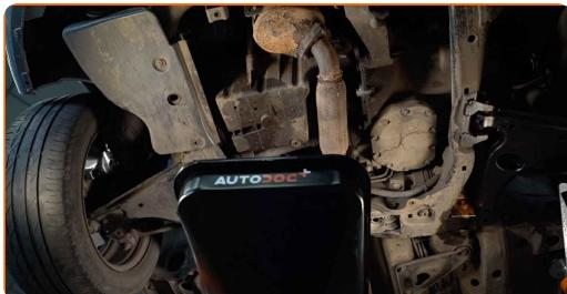
**3** Vyčistite miesto výpustného otvoru olejovej vane. Použite drôtenú kefu. Použite viacúčelový čistiaci sprej.
