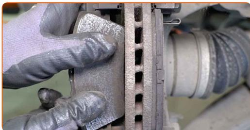
**16** Vyčistite upevňovacie prvky držiaka brzdového strmeňa. Použite drôtenú kefu. Použite sprej WD-40.
