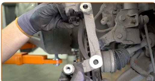
**20** Vyčistite upevňovacie prvky brzdového kotúča. Použite drôtenú kefu. Použite sprej WD-40.
