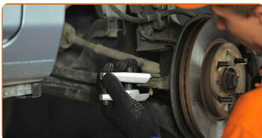
**11** Vyčistite poistnú maticu, ktorá spája tiahlo riadenia k čapu tiahla riadenia. Použite drôtenú kefu. Použite sprej WD-40.
