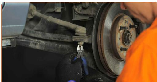
**8** Vyčistite upevnenie spájajúce čap tiahla riadenia k hlave ložiska čapu kolesa. Použite drôtenú kefu. Použite sprej WD-40.
