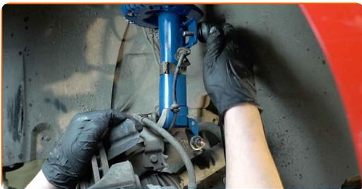
**12** Utiahnite upevnenie spájajúce vzperu stabilizátora k vzpere tlmiča. Použite kombinačný kľúč č.17. Použite nástavec č.17. Použite momentový kľúč. Utiahnite ju krútiacim momentom 40 Nm.
