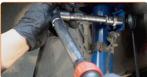
**13** Utiahnite upevnenie spájajúce vzperu stabilizátora k stabilizátoru. Použite kombinačný kľúč č.17. Použite nástavec č.17. Použite momentový kľúč. Utiahnite ju krútiacim momentom 40 Nm.
