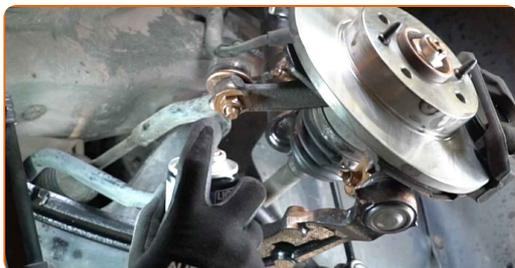
**77** Natrite povrch, kde je brzdový kotúč v kontakte s ráfikom kola. Použite medené mazivo.
