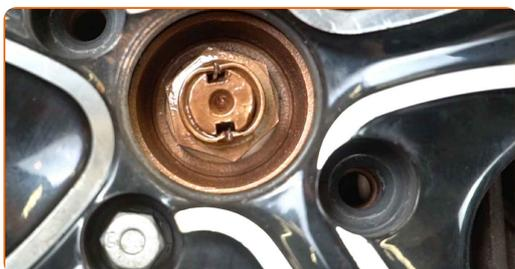
**85** Utiahnite skrutky kolies využitím krížového vzoru utiahnutia. Použite rázový nástavec na koleso č. 17. Použite momentový kľúč. Utiahnite ju krútiacim momentom 98 Nm.
