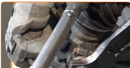
**76** Natrite upevňovacie prvky tmiča. Natrite upevnenie spájajúce čap tiahla riadenia k hlave ložiska čapu. Natrite upevňovacie prvky guľového čapu. Použite medené mazivo.
