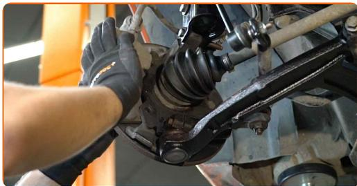
**75** Upevnite svorku brzdového strmeňa. Použite nástavec č.18. Použite momentový kľúč. Utiahnite ju krútiacim momentom 55 Nm.
