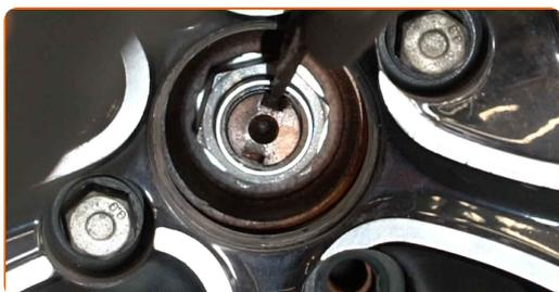
**84** Natrite upevnenie osi homokinetického kĺbu. Použite medené mazivo.
