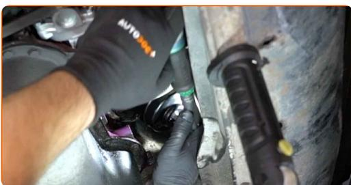
**14** Vyčistite miesto výpustného otvoru olejovej vane.
