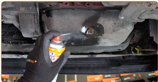
**8** Odskrutkujte výpust. Použite kombinačný kľúč č.19.
