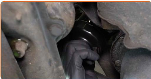
**11** Vyčistite miesto uloženia olejového filtra. Použite viacúčelový čistiaci sprej.
