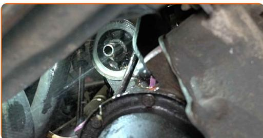
**12** Namažte gumové tesnenie nového filtra malým množstvom čerstvého oleja.
