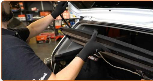
**3** Odskrutkujte upevňovacie prvky bočného plastového ozdobného panela. Použite nástavec č.10. Použite ráčňový kľúč.
