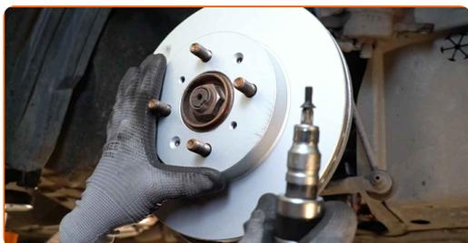
**20** Upevnite upevnenie brzdového kotúča. Použite krížový skrutkovač PH. Použite momentový kľúč. Uťahnite ju krútiacim momentom 9 Nm.
