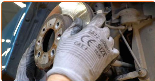
**18** Vyčistite náboj. Použite drôtenú kefu. Natrite kontaktný povrch. Použite medené mazivo.
