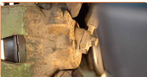
**19** Natrite povrch, kde je brzdový kotúč v kontakte s ráfikom kolesa. Použite medené mazivo.
