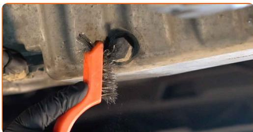
**9** Odskrutkujte výpust. Použite kombinačný kľúč č.19.
