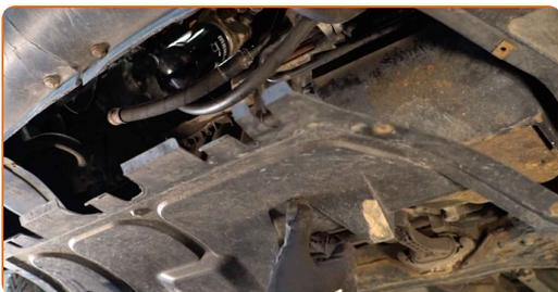
**7** Pod výpustný otvor položte nádobu na vytekající olej s objemom aspoň 5 l.
