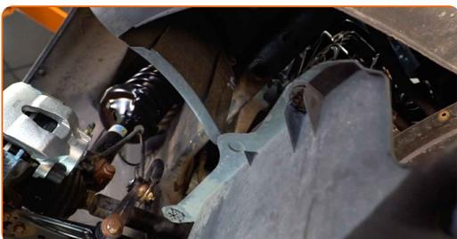
**10** Do strany vytláče napínacíu remenicu ozubeného klinového remeňa. Použite kombinačný kľúč č.16
