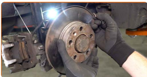
**16** Odpojte snímač ABS. Použité priebojník. Použité kladivo. Použité páčidlo.
