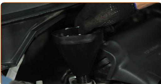
18 Nalejte olej do motora cez plniace hrdlo. Potrebné množstvo oleja: 3,6 l.
