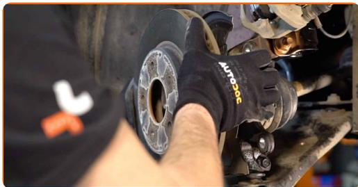
**22** Vyčistite náboj. Použite drôtenú kefu. Natrite kontaktný povrch. Použite medené mazivo.
