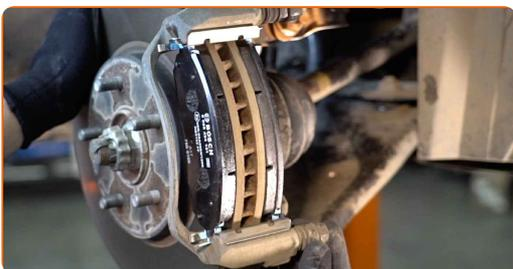
**17** Nainštalujte brzdový strmeň a upevnite ho. Použite kombinačný kľúč č.17. Použite nástavec č.14. Použite momentový kľúč. Utiahnite ju krútiacim momentom 26 Nm.
