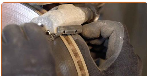
**14** Natrite piest brzdového strmeňa. Použite čistič brzd.
