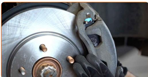
**25** Upevnite svorku brzdového strmeňa. Použite nástavec č.19. Použite momentový kľúč. Utiahnite ju krútiacim momentom 165 Nm.
