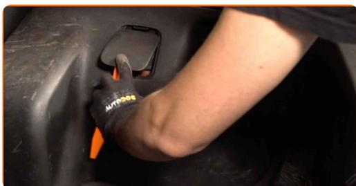
**3** Uvoľnite vrchné upevňovacie prvky tlmiča. Použite kombinačný kľúč č.16. Použite upínacie kliešte.
