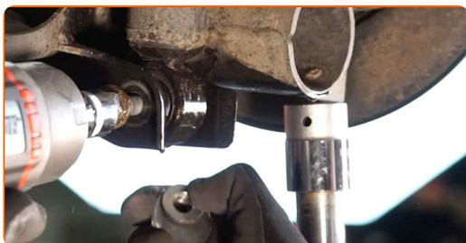
**13** Odskrutkujte vrchné upevnenie tlmiča.
