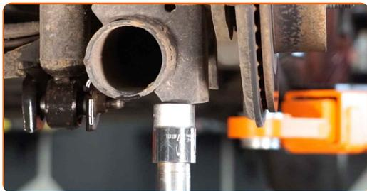
**12** Odstráňte upevňovaciu skrutku. Použite kombinačný kľúč č.18. Použite nástavec č.18.
