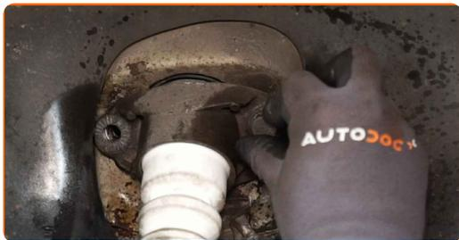
**27** Zaskrutkujte upevňovacie prvky uloženia tlmiča. Použite nástavec č.16. Použite ráčňový kľúč.
