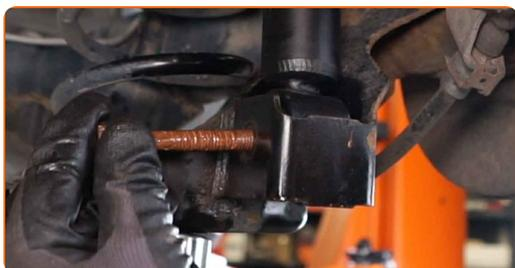
**29** Zaskrutkujte spodné upevnenie tlmiča. Použite kombinačný kľúč č.16 (2 kusy). Použite ráčňový kľúč.
