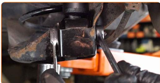
**30** Pre správne utiahnutie upevňovacích prvkov je potrebné zdvihnúť komponenty zavesenia kolies do ich pracovnej polohy. Použite zdvihák s hydraulickými prevodmi.
