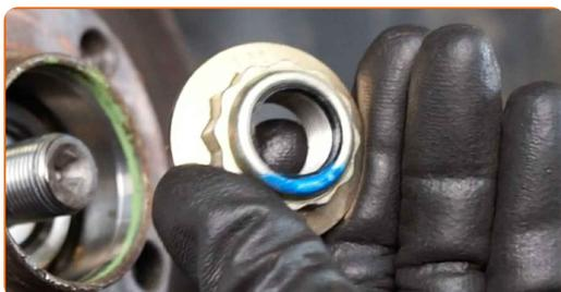
**25** Spolu odstráňte náboj a ložisko, pretože sú v jednej zostave. Použite 3-ramenný sťahovák ozubených koliesok.
