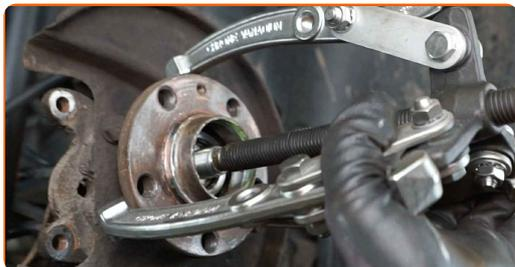
**26** Odstráňte vnútorný krúžok ložiska z čapu nápravy Použite 3-ramenný sťahovák ozubených koliesok.
