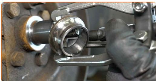
**27** Vyčistíte montážny otvor ložiska náboja. Použite drôtenú kefu. Použite viacúčelový čistiaci sprej.
