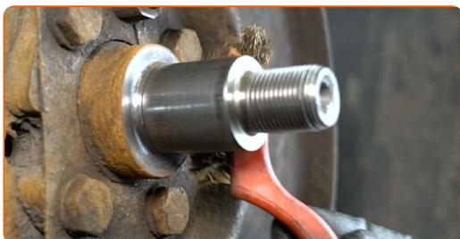
**28** Vyčistíte ABS snímač Použite nylonovú čistiacu kefu. Použite viacúčelový čistiaci sprej.
