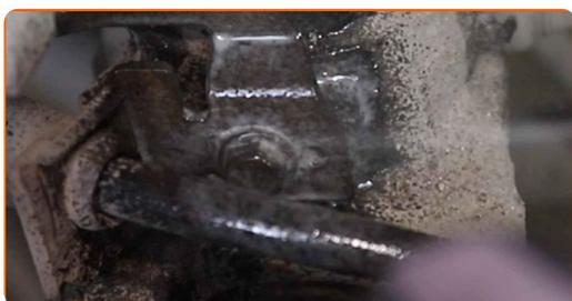
**20** Odskrutkujte upevnenie, ktoré spája svorku brzdovej hadičky k tlmiču. Použite kombinačný kľúč č.10.
