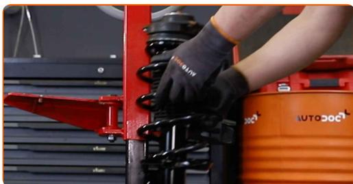
**54** Vyčistite montážne pozície vzpery tlmiča. Použite drôtenú kefu. Použite sprej WD-40.
