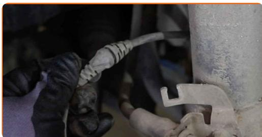
**19** Vyčistite upevnenie, ktoré spája svorku brzdovej hadičky k tlmiču. Použite drôtenú kefu. Použite sprej WD-40.
