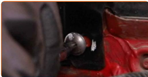
**92** Utiahnite upevňovacie prvky plastového panela. Použite hviezdicový Torx T30. Použite momentový kľúč. Utiahnite ju krútiacim momentom 8 Nm.
