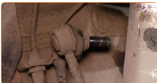
**18** Odpojte vodiče snímača ABS.
