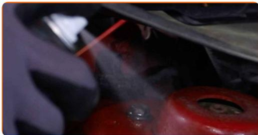
**8** Uvoľnite horné upevňovacie prvky tmiča. Použite nástavec č.13. Použite ráčňový kľúč.
