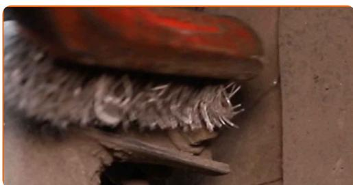
**16** Odskrutkujte upevnenie spájajúce vzperu stabilizátora k vzpere tmiča. Použite kombinačný kľúč č.18. Použite XZN č. 6. Použite ráčňový kľúč.
