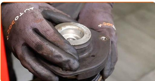
**50** Upevnite maticu piestu vzpery tlmiča. Použite 21-mm kľúč na montáž matice tlmiča. Použite imbusový kľúč č. H6. Použite momentový kľúč. Utiahnite ju krútiacim momentom 60 Nm.
