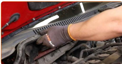
**91** Zaskrutkujte upevňovacie prvky plastového panela. Použite hviezdicový Torx T30. Použite ráčňový kľúč.
