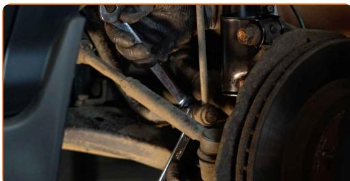
**8** Odskrutkujte upevnenie spájajúce vzperu stabilizátora k vzpere tlmiča. Použite nástavec č.17. Použite ráčňový kľúč.
