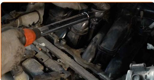
**71** Odstráňte uterák z mikrovlákná zozvodového potrubia.
