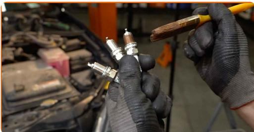
**57** Nainštalujte nové sviečky zapalovania do otvorov pre ich montáž. Použite kľúč na sviečky zapalovania č. 16. Použite ráčňový kľúč.
