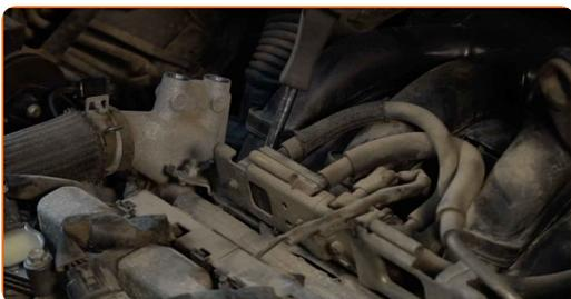
**29** Odpojte konektor senzora podtlaku. Použite plochý skrutkovač.
