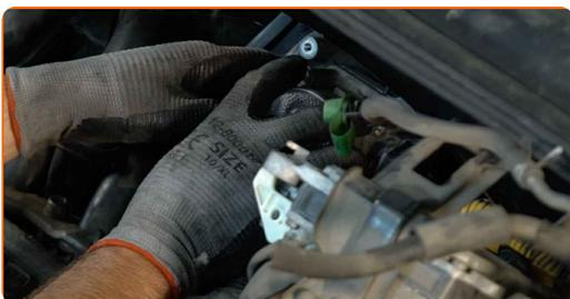
**73** Utiahnite upevňovacie prvky ventilu škrtiacej klapky. Použite nástavec č.12. Použite ráčňový kľúč.
