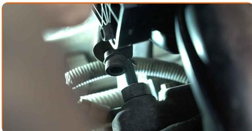
**34** Odpojte ventilačnú hadičku kľukovej skrine od krytu motora na ľavej strane.
