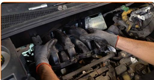
**66** Uťahnite upevnenia zvodového potrubia. Použite imbusový kľúč č. H8. Použite ráčňový kľúč.
