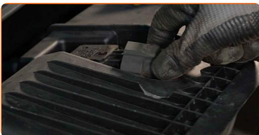
**17** Odskrutkujte svorku rezonátora nasávania vzduchu od krytu vzduchového filtra. Použite nástavec č.10. Použite ráčňový kľúč.
