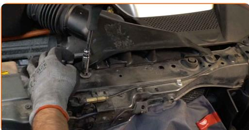
**102** Zaskrutkujte upevňovaciu svorku spájajúcu vzduchové potrubie ku krytu vzduchového filtra. Použite nástavec č.10. Použite ráčňový kľúč.
