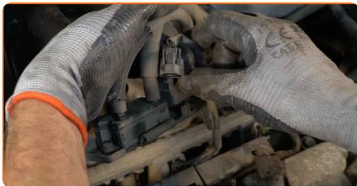
**30** Odpojte hadičku senzora podtlaku.
