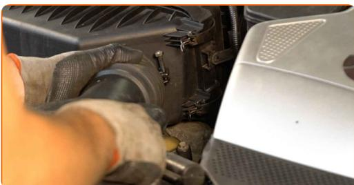
**101** Zaistite upevňovací prvok vzduchového prírodného potrubia. Použite nástavec č.10. Použite ráčňový kľúč.
