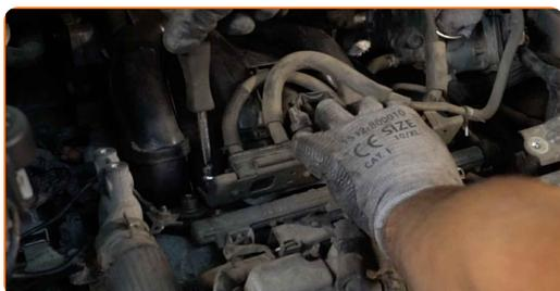
**80** Pripevnite hadičku senzora podtlaku.
