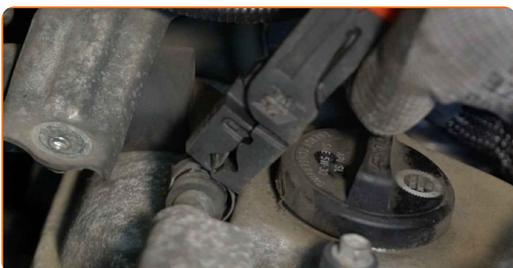
**24** Na pravej strane odpojte hadičku PCV ventilu od krytu motora.
