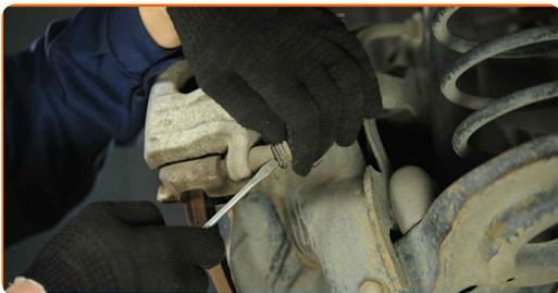
**9** Odskrutkujte upevnenie brzdoveho strmea. Pouite imbusovy klu . H7. Pouite raovy klu.
