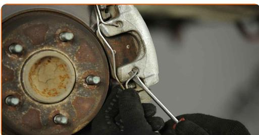
**8** Odstráňte krytky prachového puzdra vodiacich zavlaiek brzdoveho strmea. Pouite plochy skrutkova.
