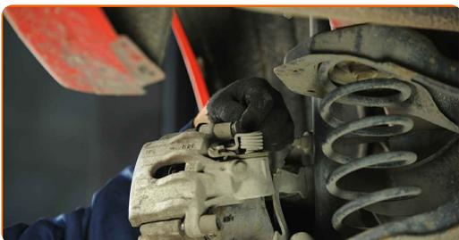
**36** Nainštalujte zádržnú pružinu brzdového strmeňa. Použite plochý skrutkovač.
