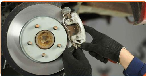
**37** Natrite povrch, kde je brzdový kotúč v kontakte s ráfikom kolesa. Použite medené mazivo.
