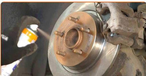
**38** Vyčistite povrch brzdového kotúča. Použite čistič brzd.
