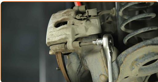
**10** Odstrate vodiace zavlaky z brzdoveho strmea. Pouite plochy skrutkova.
