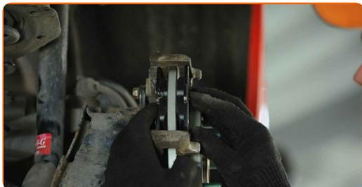
**46** Nainštalujte brzdový strmeň a upevnite ho. Použite imbusový kľúč č. H7. Použite momentový kľúč. Uťahnite ju krútiacim momentom 30 Nm.
