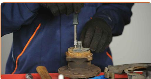
**25** Odpojte snímač ABS.
