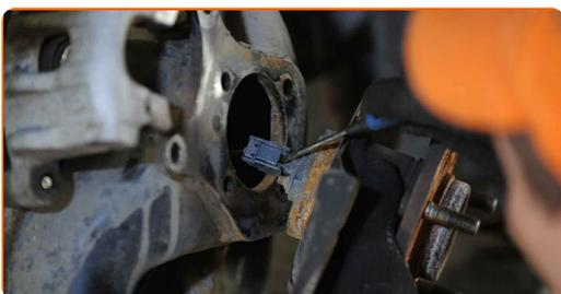
**23** Odstráňte kryt brzdového kotúča.
