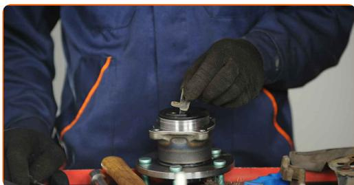
**27** Zaskrutkujte upevnenie ABS snímača. Použite nástavec č.6. Použite momentový kľúč. Uťahnite ju krútiacim momentom 5 Nm.
