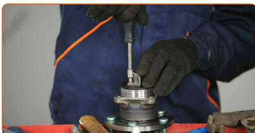
**28** Vyčistite upevňovacie prvky ložiska náboja kola. Použite drôtenú kefu. Použite sprej WD-40.
