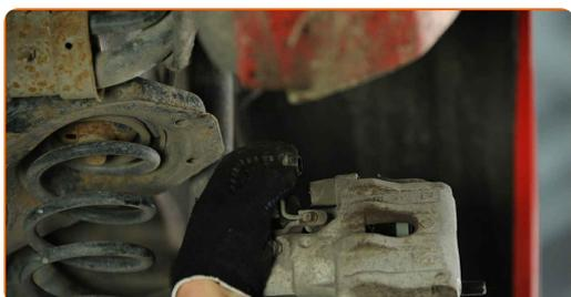
**8** Vyčistite upevňovacie prvky brzdového strmeňa. Použite drôtenú kefu. Použite sprej WD-40.
