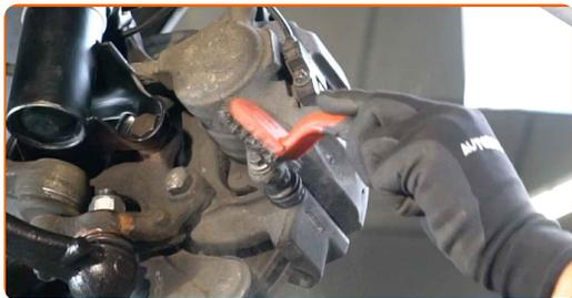
**9** Odskrutkujte upevnenie brzdového strmeňa. Použijete nástavec č.12. Použijete ráčňový kľúč.
