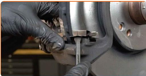
**14** Očistite brzdový strmeň od prachu a špiny. Použite drôtenú kefu. Použite čistič brzd.
