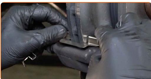
**16** Natrite brzdové platničky v mieste, kde sa ich povrch dostáva do kontaktu s držiakom brzdového strmeňa. Použite pastu proti pískaniu brzd.
