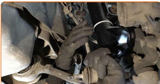
Výmena: tyčky stabilizátora – MERCEDES-BENZ CLK (C209). Tip od AUTODOC:
