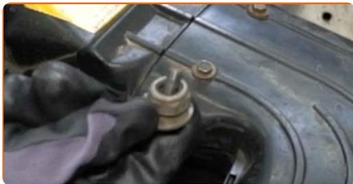
**6** Odstráňte prívodné potrubie.
