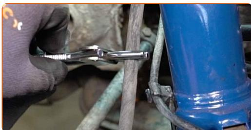
**15** Uvoľnite upevnenie brzdovej hadičky. Použite kombinačný kľúč č.14.
