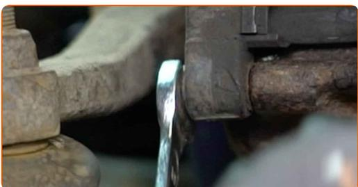
**64** Natrite zástrčku senzora opotrebenia brzdovej platničky. Použite dielektrické mazivo.
