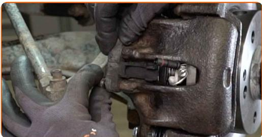
**63** Zaskrutkujte upevňovací prvok konektora snímača opotrebenia brzdovej platničky. Použite kombinačný kľúč č.10.
