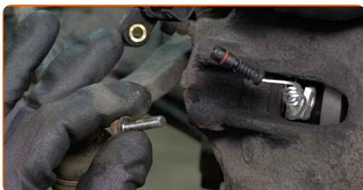
**12** Odpojte konektor snímača opotrebenia brzdovej platničky.
