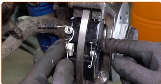
**50** Nainštalujte brzdový strmeň a upevnite ho.
