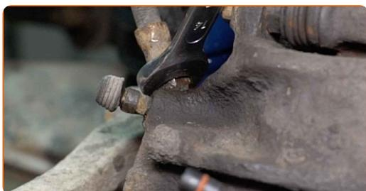
**16** Vyčistite upevňovacie prvky brzdového strmeňa. Použite drôtenú kefu. Použite sprej WD-40.
