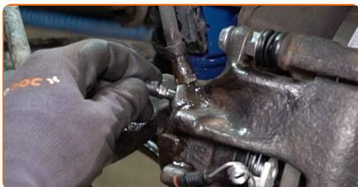
**61** Nainštalujte konektor snímača opotrebenia brzdovej platničky.
