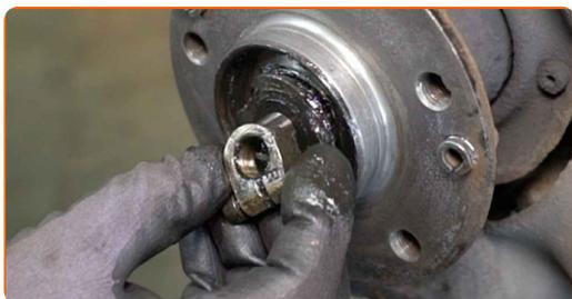
**22** Odstráňte náboj kolesa spolu s ložiskom. Použite univerzálny sťahovač.
