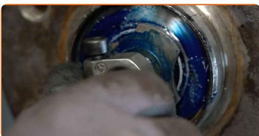
**34** Natrite kontaktný povrch. Použite keramické mazivo.
