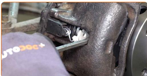
**11** Odskrutkujte upevňovacie prvky držiaka brzdového strmeňa. Použite nástavec č.19. Použite ráčňový kľúč.
