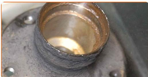
**28** Nainštalujte vonkajšie krúžky nových ložísk kola. Použite sadu vložky a orechu ložiska.
