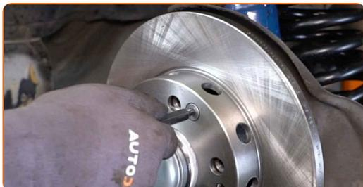
**37** Uťahnite upevňovacie prvky brzdového kotúča. Použite imbusový kľúč č. H5. Použite momentový kľúč. Uťahnite ju krútiacim momentom 10 Nm.
