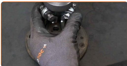
**27** Vyčistite montážne pozície ložísk kola. Použite viacúčelový čistiaci sprej.
