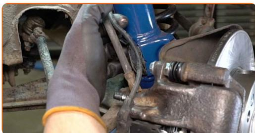
**9** Vyčistite upevňovacie prvky držiaka brzdového strmeňa. Použite drôtenú kefu. Použite sprej WD-40.
