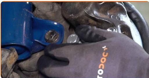
**40** Utiahnite upevňovacie prvky držiaka brzdového strmeňa. Použite nástavec č.19. Použite momentový kľúč. Utiahnite ju krútiacim momentom 115 Nm.
