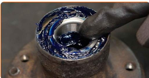
**31** Zatlačte vnútorné olejové tesnenie ložiska kolesa. Použite sadu vložky a orechu ložiska.
