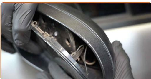
**2** Opatrne uvoľnite sklo spätného zrkadla z jeho pripevnenia.
