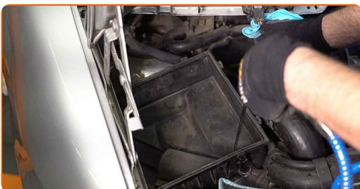
Výmena: vzduchový filter – MERCEDES-BENZ Sprinter 4-T Bus (W904).
