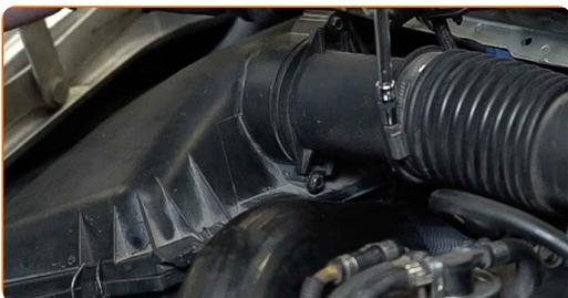
4 Odpojte rúrku na prívod vzduchu od krytu vzduchového filtra. Použite páčidlo.
