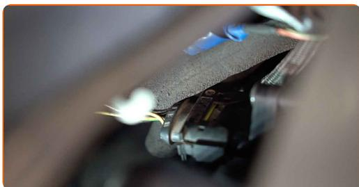
18 Upevnite svorku na vzduchovej prívodnej hadičke. Použite nástavec č.7. Použite ráčňový kľúč.
