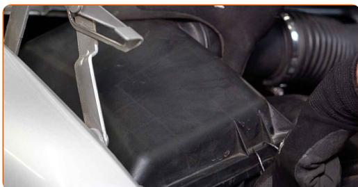
16 Zaskrutkujte skrutky krytu vzduchového filtra. Použite križový skrutkovač PH.
