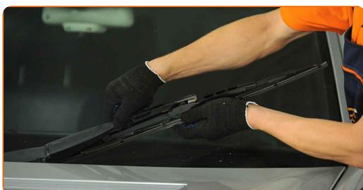
Výmena: stieračov – MERCEDES-BENZ SPRINTER 4-t Korba/Podvozok (907).
