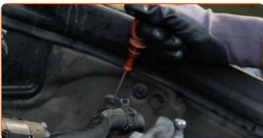
6 Vyčistite uzáver krytu olejového filtra. Použite viacúčelový čistiaci sprej.
