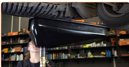
**14** Vyčistite miesto výpustného otvoru olejovej vane. Použite drôtenú kefu. Použite viacúčelový čistiaci sprej.
