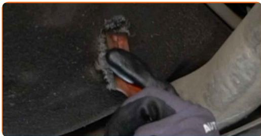
**15** Odskrutkujte výpust. Použite nástavec č.13. Použite ráčňový kľúč.
