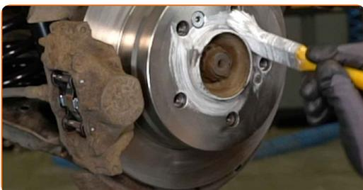
**46** Vyčistite povrch brzdového kotúča. Použite čistič brzd.
