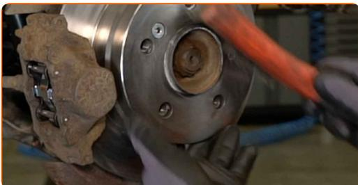
**45** Natrite povrch, kde je brzdový kotúč v kontakte s ráfikom kolesa. Použite keramické mazivo.
