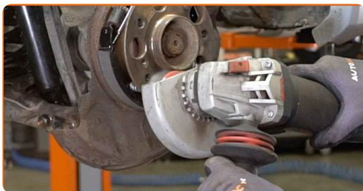
**33** Natrite kontaktný povrch. Použijte keramické mazivo.
