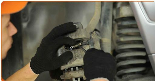
9 Odstráňte krytky prachového puzdra vodiacich závlačiek brzdového strmeňa. Použite plochý skrutkovač.
