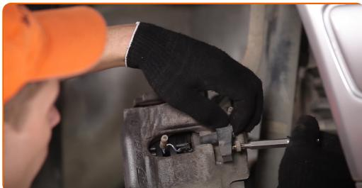
11 Vyčistite upevňovacie prvky brzdového strmeňa. Použite drôtenú kefu. Použite sprej WD-40.
