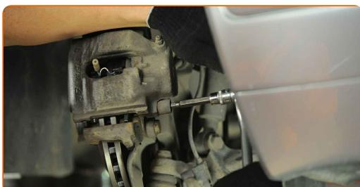
13 Odstráňte vodiace závlačky z brzdového strmeňa.
