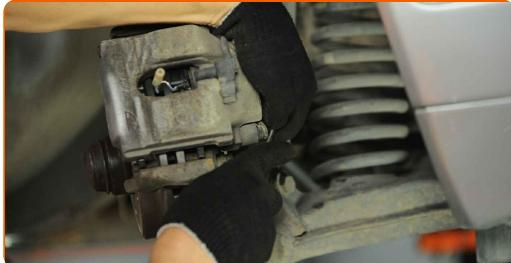
10 Odpojte snímač opotrebenia brzdových platničiek. Použite hviezdicový Torx T30. Použite ráčňový kľúč.
