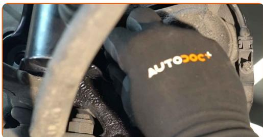
**48** Zaskrutkujte upevňovacie prvky spájajúce tlmáč k hlave ložiska čapu kolesa. Použite nástavec č.19. Použite ráčňový kľúč.
