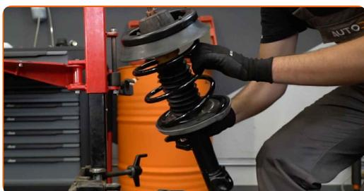
**38** Natrite montážne pozície tlmiča pruženia. Použite drôtenú kefu. Použite sprej WD-40.
