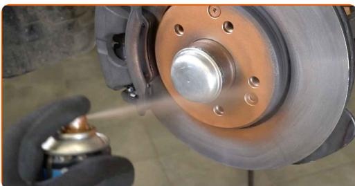
**59** Vyčistite povrch brzdového kotúča. Použite čistič brzd.
