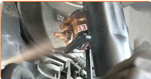
**58** Natrite povrch, kde je brzdový kotúč v kontakte s ráfikom kolesa. Použite medené mazivo.
