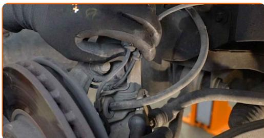
**14** Odpojte vodiče snímača ABS.
