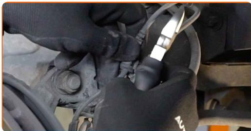
**15** Odpojte kábel snímača opotrebovania brzdovej platničky.
