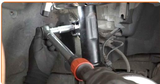
**57** Namažte všetky spojenia vzpery stabilizátora. Natrite upevňovacie prvky tlmiča. Použite medené mazivo.
