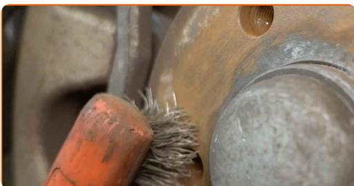
**16** Natrite povrch, kde je brzdový kotúč v kontakte s ráfikom kolesa. Použite keramické mazivo.
