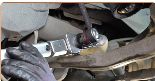
**13** Utiahnite upevnenie spájajúce vzperu stabilizátora k vzpere tlmiča. Použite nástavec č.19. Použite momentový kľúč. Utiahnite ju krútiacim momentom 98 Nm.
