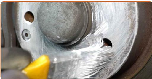
**17** Vyčistite povrch brzdového kotúča. Použite čistič brzd.
