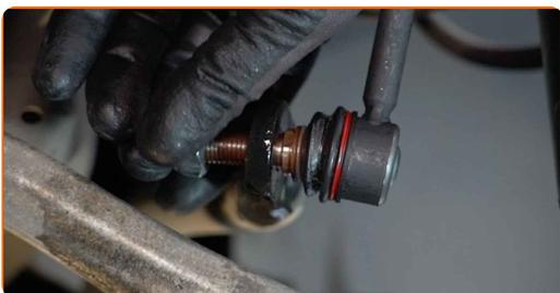
**12** Utiahnite upevnenie spájajúce vzperu stabilizátora k stabilizátoru. Použite nástavec č.19. Použite momentový kľúč. Utiahnite ju krútiacim momentom 98 Nm.
