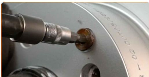
**26** Upevnite upevnenie brzdového kotúča. Použite imbusový kľúč č. H5. Použite momentový kľúč. Utiahnite ju krútiacim momentom 10 Nm.
