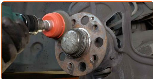
**23** Natrite kontaktný povrch. Použite keramické mazivo.
