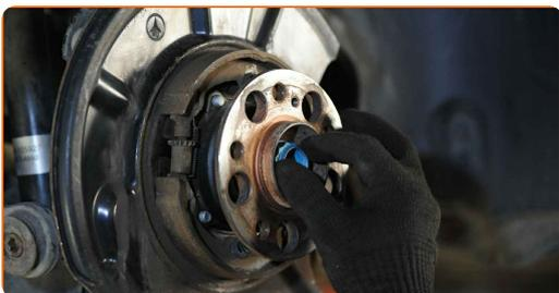
**82** Upevnite náboj. Použite nástavec č.32. Použite momentový kľúč. Utiahnite ju krútiacim momentom 170 Nm.+45°
