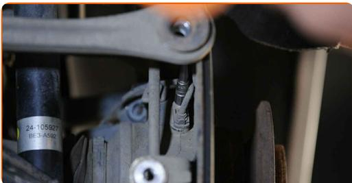
**39** Odpojte snímač ABS.
