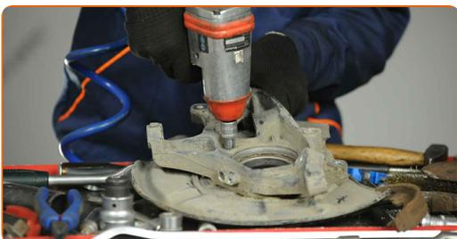
**45** Odstráňte upevnenie ložiska náboja. Použite kladivo.
