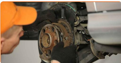
**80** Vložte mechanizmus nastavenia čelustí brzdy. Použite kliešte. Použite okrúhle kliešte. Použite plochý skrutkovač.
