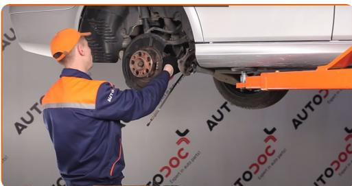
**33** Odskrutkujte upevňovacie prvky horného priečného ramena. Použite kombinačný kľúč č.18. Použite nástavec č.E18. Použite ráčňový kľúč.
