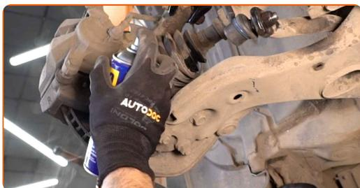
**7** Odskrutkujte upevnenie svorky brzdového strmeňa. Použite kombinačný kľúč č.18. Použite nástavec č.18. Použite ráčňový kľúč.
