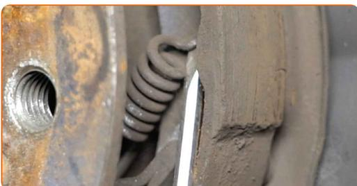
**23** Odstráňte zádržné pružiny čelústí parkovacej brzdy. Použite dlhé kliešte.
