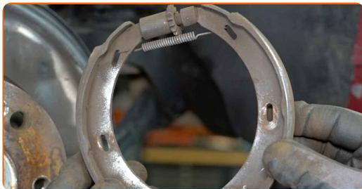
**25** Vyčistite montážne pozície čelustí parkovacej brzdy. Použite drôtenú kefu. Použite viacúčelový čistiaci sprej.
