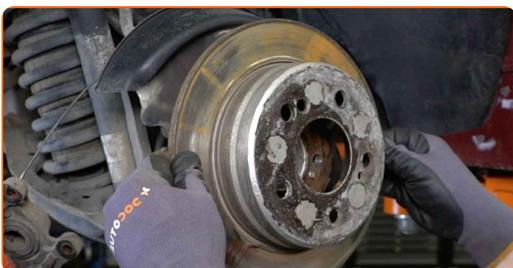
**22** Odstráňte spodnú vratnú pružinu brzdovej čelúste. Použite plochý skrutkovač.
