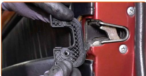
**4** Odpojte ozdobný panel kľučky dverí. Použite plastový nástroj na demontáž čalúnenia.
