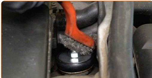
**5** Uvoľnite vrchné upevňovacie prvky tlmiča. Použite špeciálny nástavec na odstránenie tlmiča č. 16. Použite rozperný nástavec na demontáž tlmičov č. DD6. Použite ráčnový kľúč.
