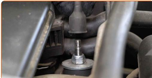
4 Vyčistite horné upevnenie tlmiča. Použite drôtenú kefu. Použite sprej WD-40.
