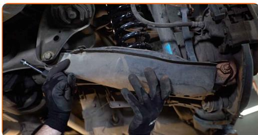
18 Zaskrutkujte upevňovacie prvky plastového krytu ovládacieho ramena. Použite nástavec č.10. Použite ráčňový kľúč.
