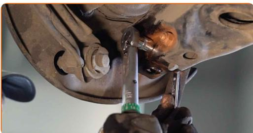
16 Namažte všetky spojenia vzpery stabilizátora. Použite medené mazivo.
