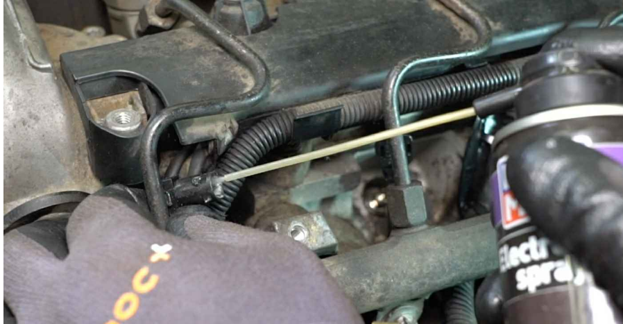
18 Pripevnite konektory elektrického vedenia žeraviacich sviečok. Použite špicaté kliešte.
